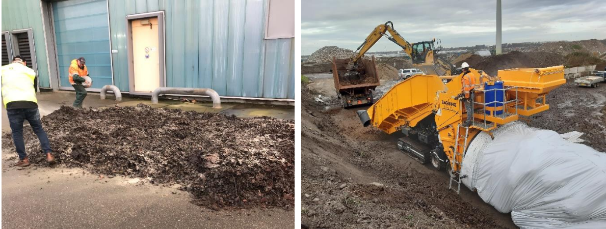
Figuur 3.2. Aanleg van de bokashi-kuil door het handmatig aanbrengen van hulpstoffen op bedrijf 4 (links) en het aanbrengen van groene reststromen met de bagging machine en feedtuber op bedrijf 5 (rechts).
