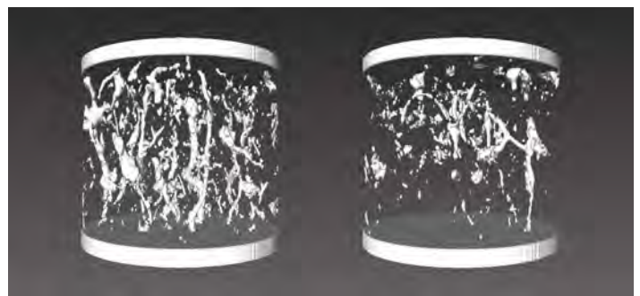
Fig. 5.3. CT scan macro poriën van de bodem (kleigrond) van ongestoorde bodem (links) en (29 jaar geleden) belaste bodem met 50 kN (Schjønning et al., 2015).
