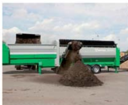
Cribs - De eerste volledig elektrische trommelzeef
