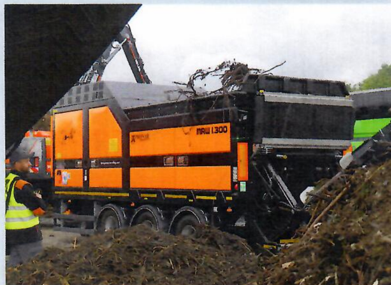
Voor het eerst in Nederland en na de BVOR Demodagen als demomachine inzetbaar was deze Pronar MRW 1300, een enkelassige langzaamdraaier met een drie meter lange as. Binnenkort is hij desgewenst leverbaar met meerdere opties voor beitels, tegenkammen en korven.
