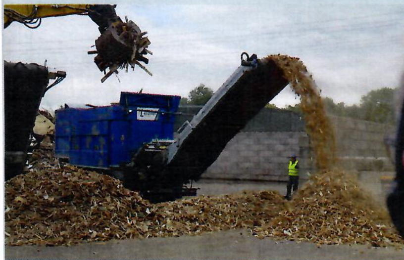
Van Bommel toonde deze enkelassige Eggersmann Teuton 55-langzaamdraaier met een tegenkam met negentien V-vormige snijkammen die op tien verschillende posities ten opzichte van de rotor kunnen worden gezet. In combinatie met het toerental en de zeefkorf is de machine geschikt voor verschillende soorten materialen.
