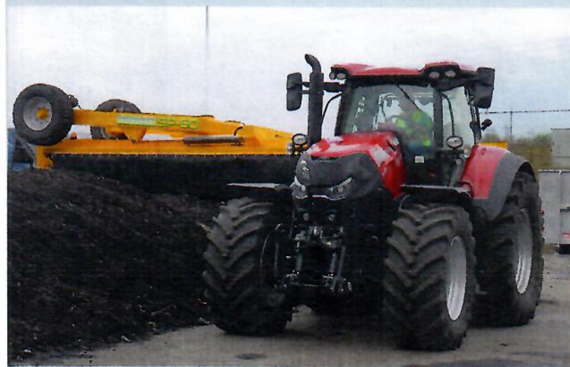
Een machine voor de cumelaondernemer die kleinere eenheden (eventueel op locatie) omzet, is deze getrokken Menart SP 60. Die is met 2,70 meter tunnelbreedte en 2,20 meter hoogte de grootste getrokken versie.
