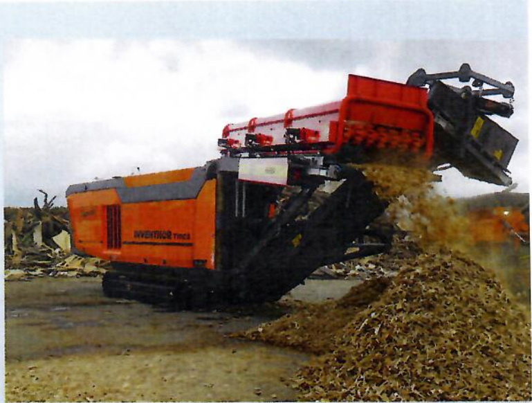
Een opvallende innovatie is deze Doppstadt Inventhor 9-langzaamdraaier met af-fabriek opgebouwde HS 814-sterrenzeef om met behoud van een grote capaciteit in één keer op maat eindproduct te realiseren.
